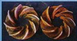
Cast iron impeller crack after 500 hrs. ใบพัดเหล็กหล่อแตกหลังจากผ่านไป 500 ชม.
