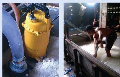
Pumping powder liquid ปั๊มน้ำแป้ง น้ำข้าวในโรงงานขนมจีน
